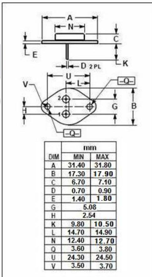
**isc Silicon NPN Power Transistor****2N4240****ELECTRICAL CHARACTERISTICS** $T_C=25^\circ\text{C}$  unless otherwise specified
