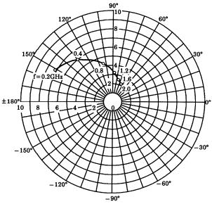
$S_{12e}$   $V_{CE}=6V$   $I_{C}=7mA$   $T_{a}=25^{\circ}C$
