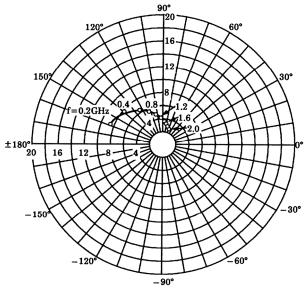
$S_{12e}$   $V_{CE}=6V$   $I_{C}=3mA$  $T_{a}=25^{\circ}C$
