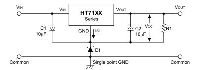
$$V_{\rm OUT} = V_{\rm XX} + V_{\rm D1}$$
