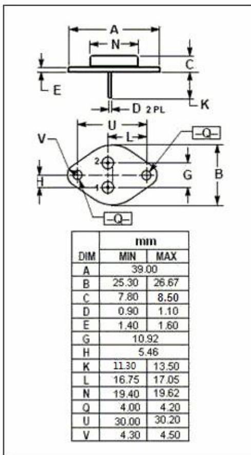
**isc Silicon NPN Power Transistor****2N4395****ELECTRICAL CHARACTERISTICS** $T_c=25^\circ C$  unless otherwise specified
