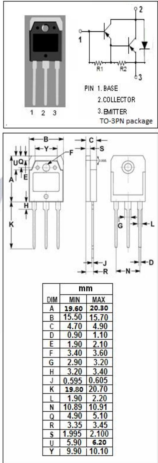
**isc Silicon PNP Darlington Power Transistor****2STW200****ELECTRICAL CHARACTERISTICS** $T_c=25^\circ C$  unless otherwise specified
