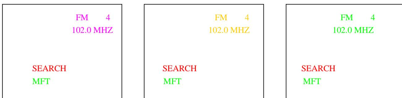
2:按音量加减键搜台,搜台过程中,台标跟频率显黄色,搜到台显紫色,若一直收不到台,高端到 108M 停止搜台,低端到 87.5M 停止搜台,台标跟频率显紫色。DISP 退出。
