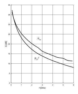
Power gain  $G_{ma}$ ,  $G_{ms} = f (V_{CE})$  $I_{C} = 60 \text{ mA}$ f = parameter
