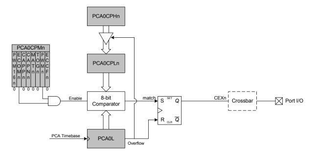
Figure 25.8. PCA 8-Bit PWM Mode Diagram
