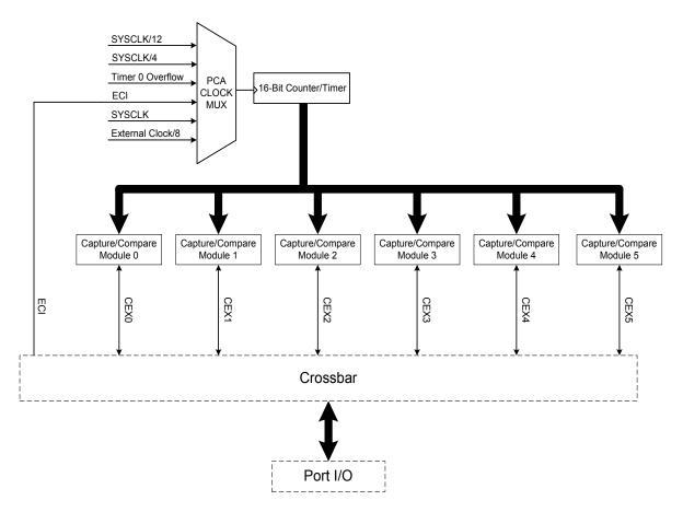
Figure 1.10. PCA Block Diagram
