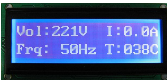
图 8.8c EG8010 连接 12832 工作时液晶屏显示信息
