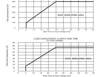
LOAD CAPACITANCE vs INPUT RISE TIME
