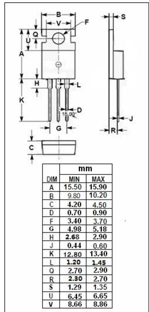
**isc N-Channel MOSFET Transistor****IRF520N****ELECTRICAL CHARACTERISTICS**T<sub>C</sub>=25°C unless otherwise specified
