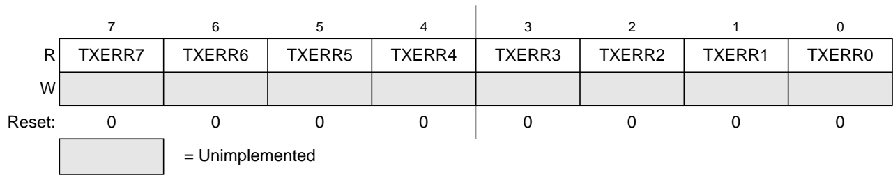
Figure 12-16. MSCAN Transmit Error Counter (CANTXERR)
