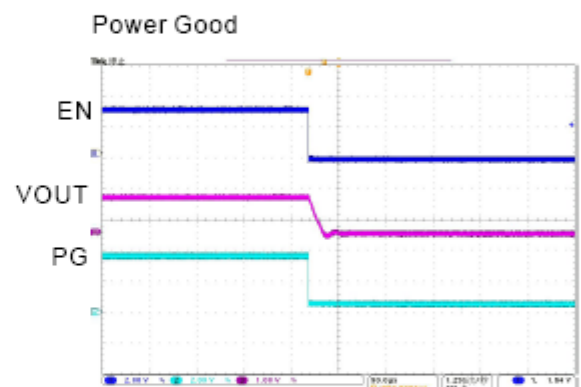
V_{in}=3.3\text{V} , V_o=1.2\text{V} , I_o=1\text{A}
