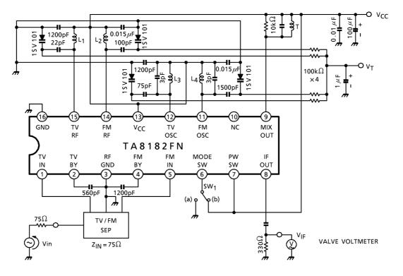
$G_C (dB) = 20 \ell og V_{IF} (\mu V_{rms}) - (V_{in} (dB\mu V EMF) - 6dB)$  TV / FM separator: GTVS03 (SOSHIN ELECTRIC CO.,LTD.)
