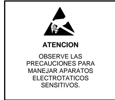
**ADVERTENCIA: Aparato electrostático sensible. Use las precauciones de manejo CMOS/MOSFET apropiadas para evitar descargas electrostáticas. AVISO: Bandas o pulseras para muñecas**
