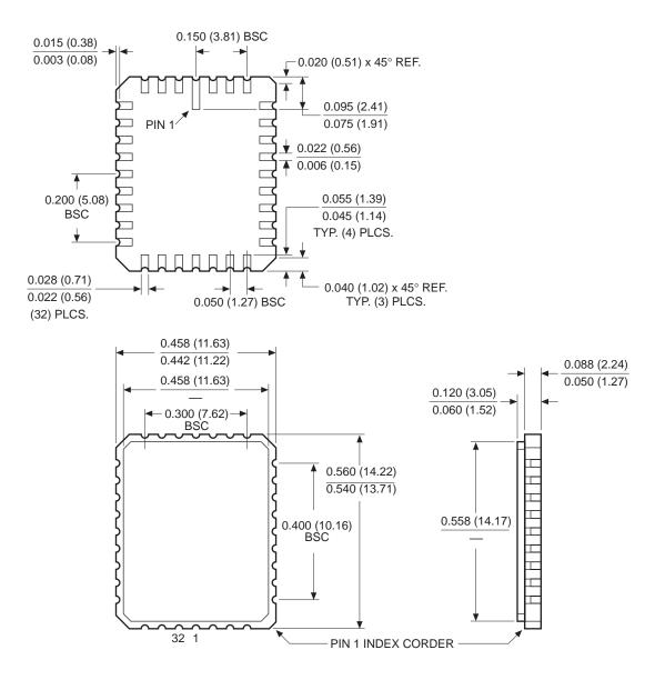
32-PAD CERAMIC LEADLESS CHIP CARRIER PACKAGE TYPE E
